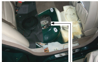
CENTRALINA COMANDO POMPA BENZINA SITUATA SOTTO AL SEDILE POSTERIORE LATO PASSEGGERO PETROL PUMP ECU LOCATED BELOW THE REAR SEATS PASSENGER SIDE
